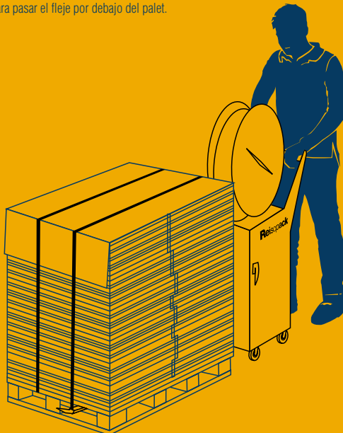
La máquina se desplaza manualmente hacia el palet evitando mover la carga antes del flejado.
